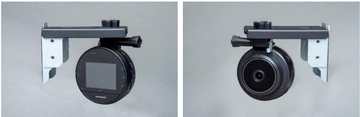
端末寸法: W11.9cm × D6.4cm × H9.9cm 建設機械のキャビン内部に設置して使用します。
