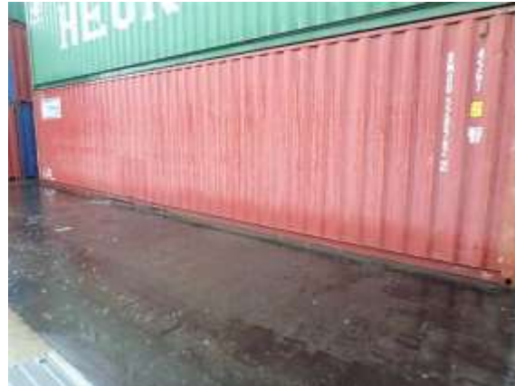
冠水したと思われるコンテナ
