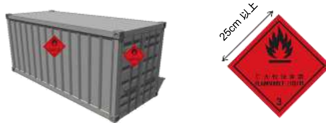
図.5-3 コンテナへの標識の一例
